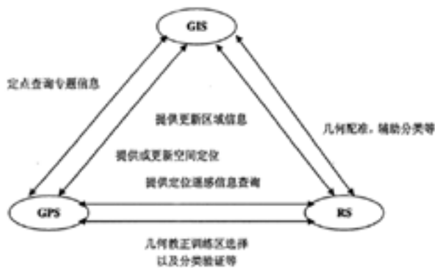
图 1 3S 集成技术工作结构图
